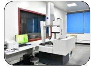
Máquina de medición de coordenadas Zeiss (CMM) (hecha en Alemania)
