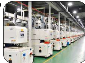
Conjunto de equipos de moldeo por inyección (hecho en Japón)
