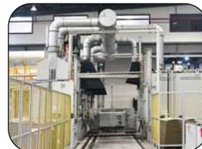
Equipo de carburación IPSEN (hecho en Alemania)
